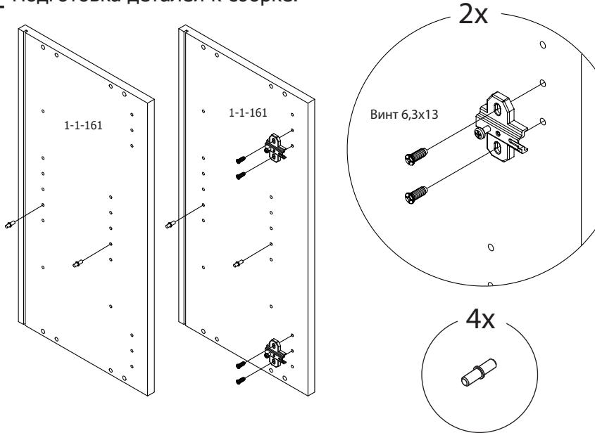
Способ установки планок петель для дверей: 1ДРс\_60-45 и 1ДРс\_60-50
