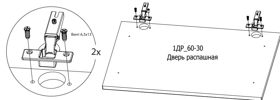
В большинстве моделей кухонь ДВЕРИ РАСПАШНЫЕ (ДР) являются универсальными. При этом перед установкой необходимо определить желаемое направление открывания двери и в зависимости от этого досверлить уже имеющиеся на ней глухие отверстия под ручку на твердой поверхности, во избежание вырывания передней пласти двери.
