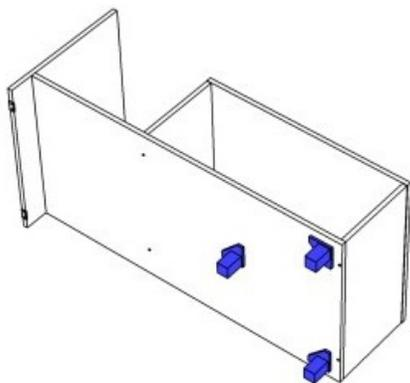
С помощью саморезов 3,5x19 закрепить опоры по разметке
